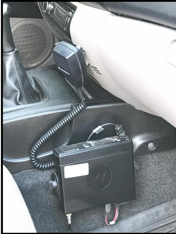
Imagen. Radio comunicador instalado en vehículo de combate de incendios.
