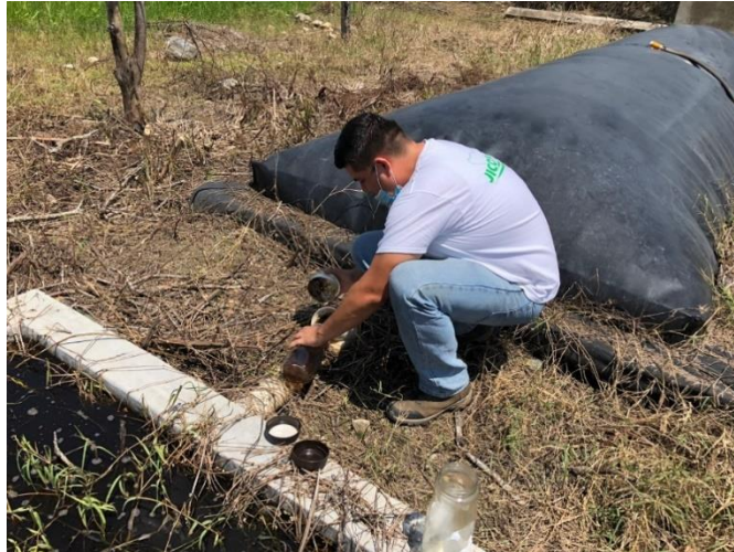
Toma de muestras de Biol en Biodigestor de Villa Purificación
