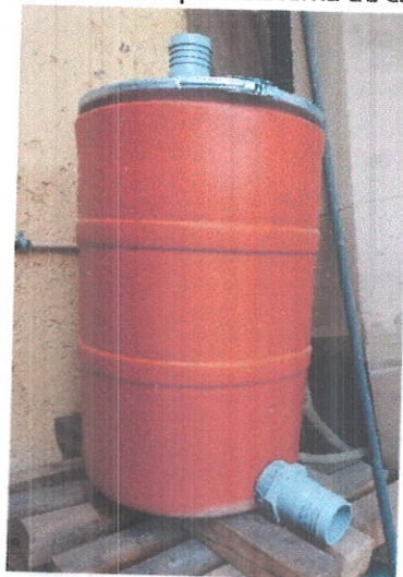
Filtro rústico de carbón y arena
